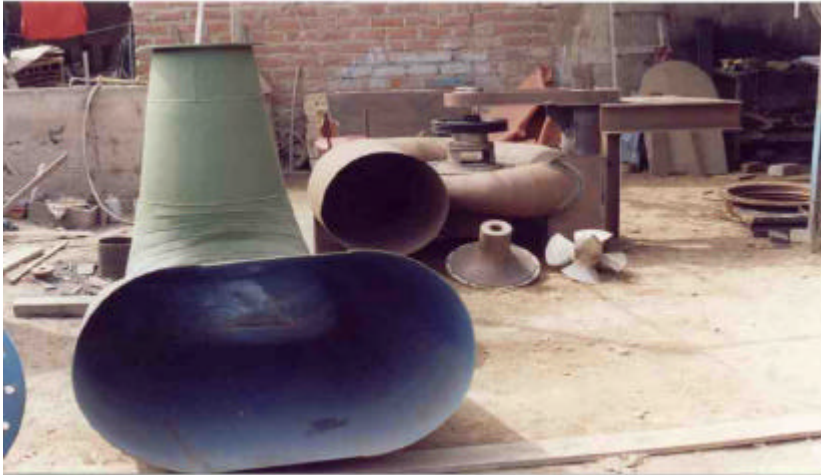
Figura 3: Tubo de succión fabricado en planchas de acero
