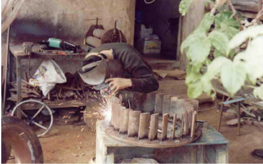
Figura 15: Ubicación de los álabes directrices mediante
