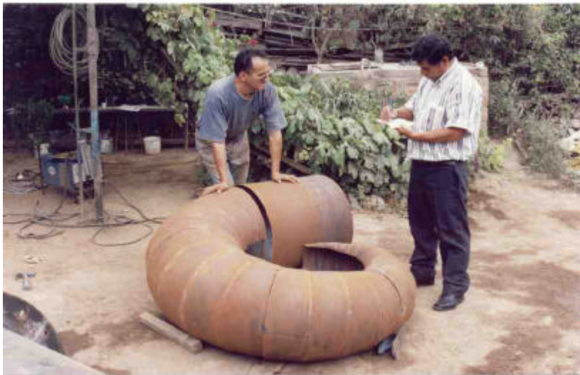
Figura 12: Unión por soldadura de los segmentos de la espiral
